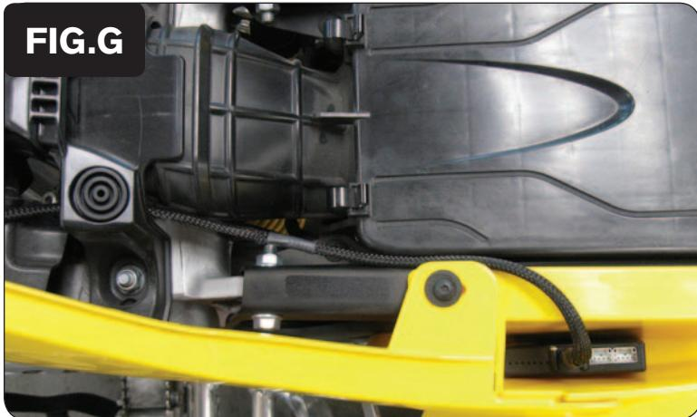
10. Installare il PCV nell' alloggiamento presente sul parafango posteriore (Fig. G).
