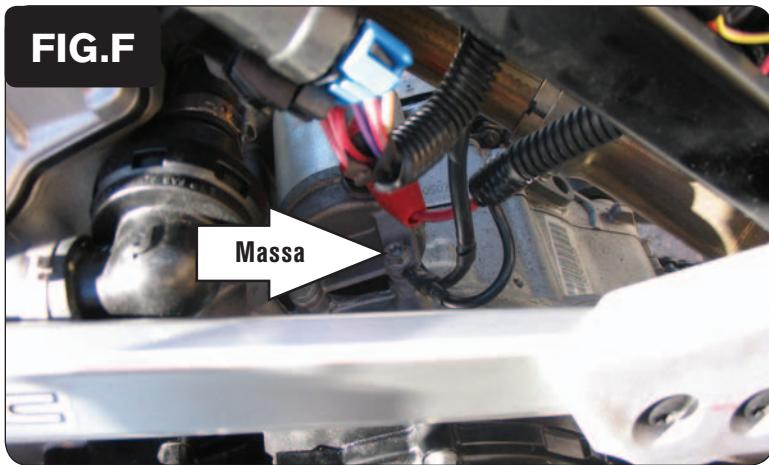
9. Collegare il cavo di massa del PCV al nodo masse originale del veicolo (Fig. F).
