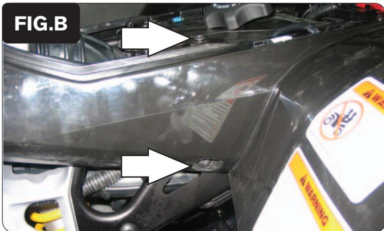
3. Rimuovere le 2 viti del parafango posteriore mostrate in Fig. B. ripetere questa operazione anche per la viti sul lato destro del veicolo.
