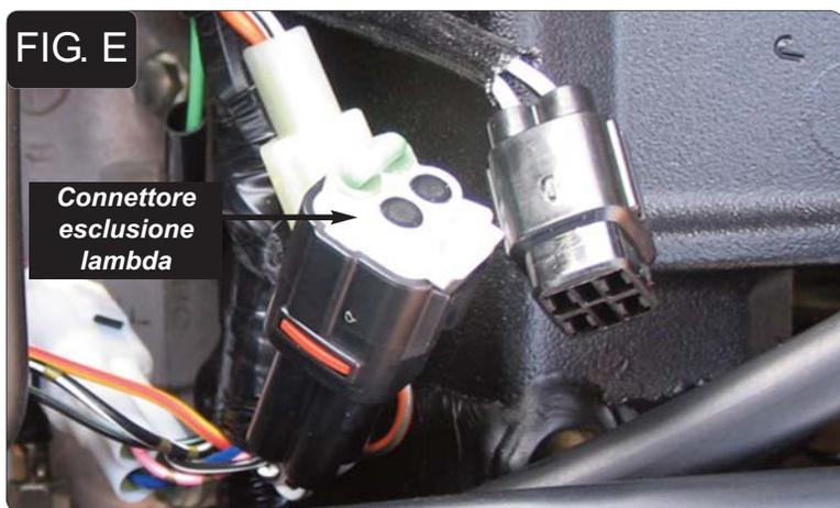
10. Localizzare la connessione della sonda lambda al cablaggio principale. Questo connettore è di colore NERO a 4 pin e si trova sotto la carenatura destra. La carenatura dovrà essere allontanata dal telaio ma non completamente rimossa.
