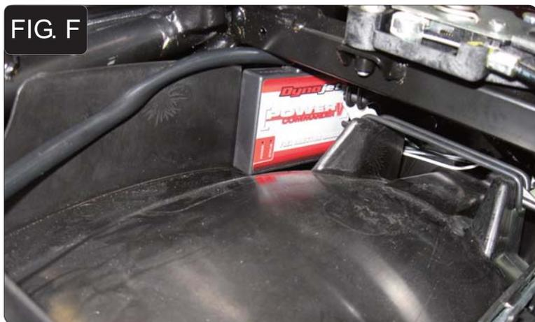
13. Fissare il PCV nell'area sottosella utilizzando il velcro fornito. Pulire entrambe le superfici con la salvietta in alcool fornito prima di applicare le parti adesive.
