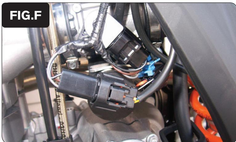
8. Collegare il PCV in linea con il Sensore Posizione Farfalla (TPS) ed il cablaggio originali (Fig. F).
