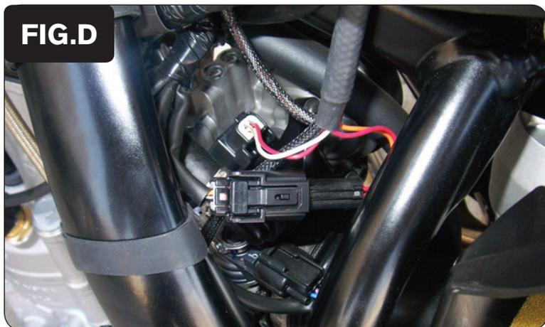
6. Collegare il PCV in linea con l'iniettore ed il cablaggio originali (Fig. D).
