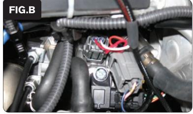
3. Collegare il PCV in linea con il cablaggio originale e l'iniettore (Fig. B).
