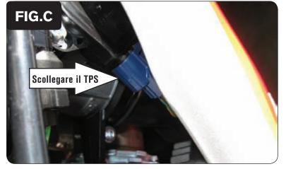
4. Scollegare il cablaggio originale dal Sensore di Posizione Farfalla (Fig. C).
