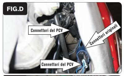
5. Collegare il cablaggio del PCV in linea con il cablaggio originale ed il TPS (Fig. D).
