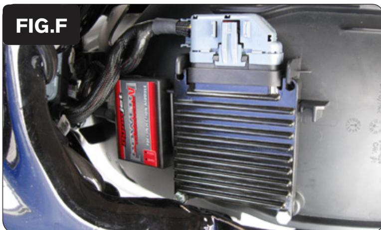
8. Fissare il PCV al contenimento in plastica di fronte alla centralina originale (Fig. F).
