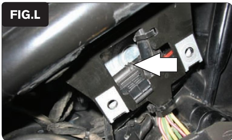
16. Scollegare il connettore della sonda lambda dal cablaggio della moto (Fig. L).
