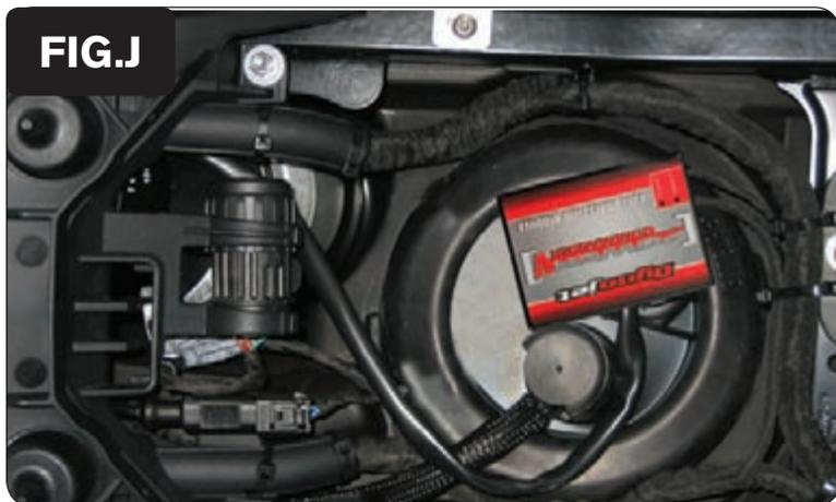
14. Fissare l'unità PCV come mostrato nella figura J, utilizzando il velcro fornito (Fig. J).
