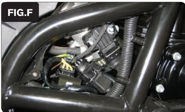
11. Collegare i connettori del PCV in linea con il cablaggio ed il sensore TPS originali (Fig. F).
