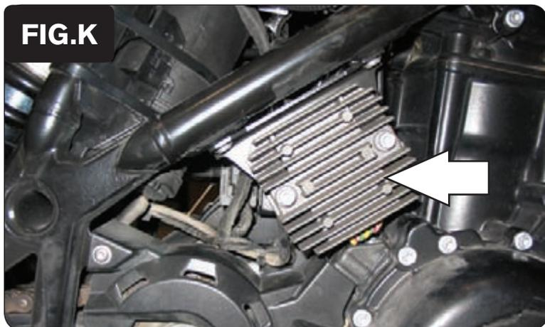
15. Rimuovere il regolatore di tensione per accedere al connettore della sonda lambda (Fig. K).
