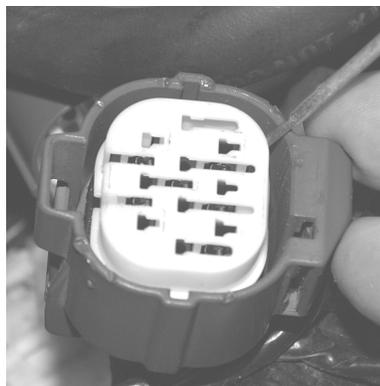
6. Rimuovere i due pin centrali del connettore (vedi immagine), esattamente quelli con i fili di colore :
