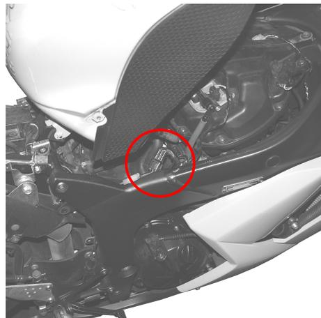
27. Tenere il **connettore maschio** (il più piccolo) con i dentini di fissaggio rivolti in alto.
