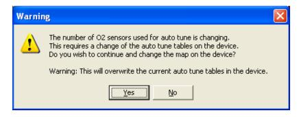
Il numero delle sonde lambda utilizzate per l' auto tune sta per essere cambiato. Ciò richiede la variazione delle tavole auto tune nel dispositivo. Si vuole procedere e cambiare la mappa nel dispositivo?
