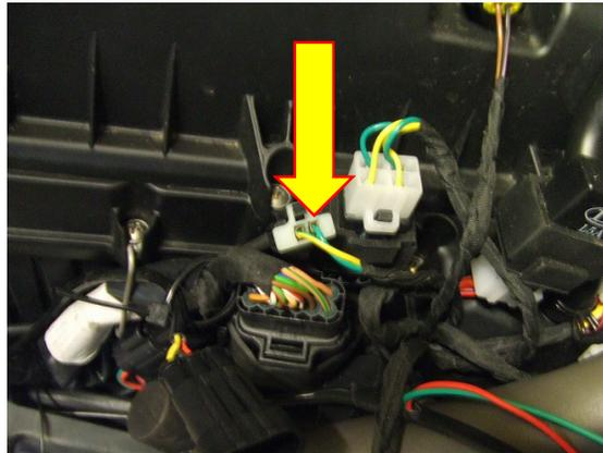
4. Localizzare la bobina del cilindro posteriore. Sul connettore a 3 pin di collegamento della bobina individuare il filo di colore AZZURRO/VERDE. Utilizzando il morsetto ruba corrente fornito collegare il filo Nero/Verde (segnale RPM) del cablaggio GPX-A01 al filo Azzurro/Verde originale.
