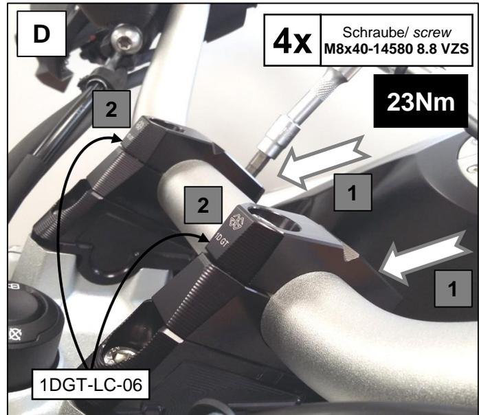
Beachten Sie die zweite Montageposition der Klemmböcke. Sie können sich schon vor diesem Arbeitsgang für eine der beiden Einstellungen entscheiden (Schritt I).
