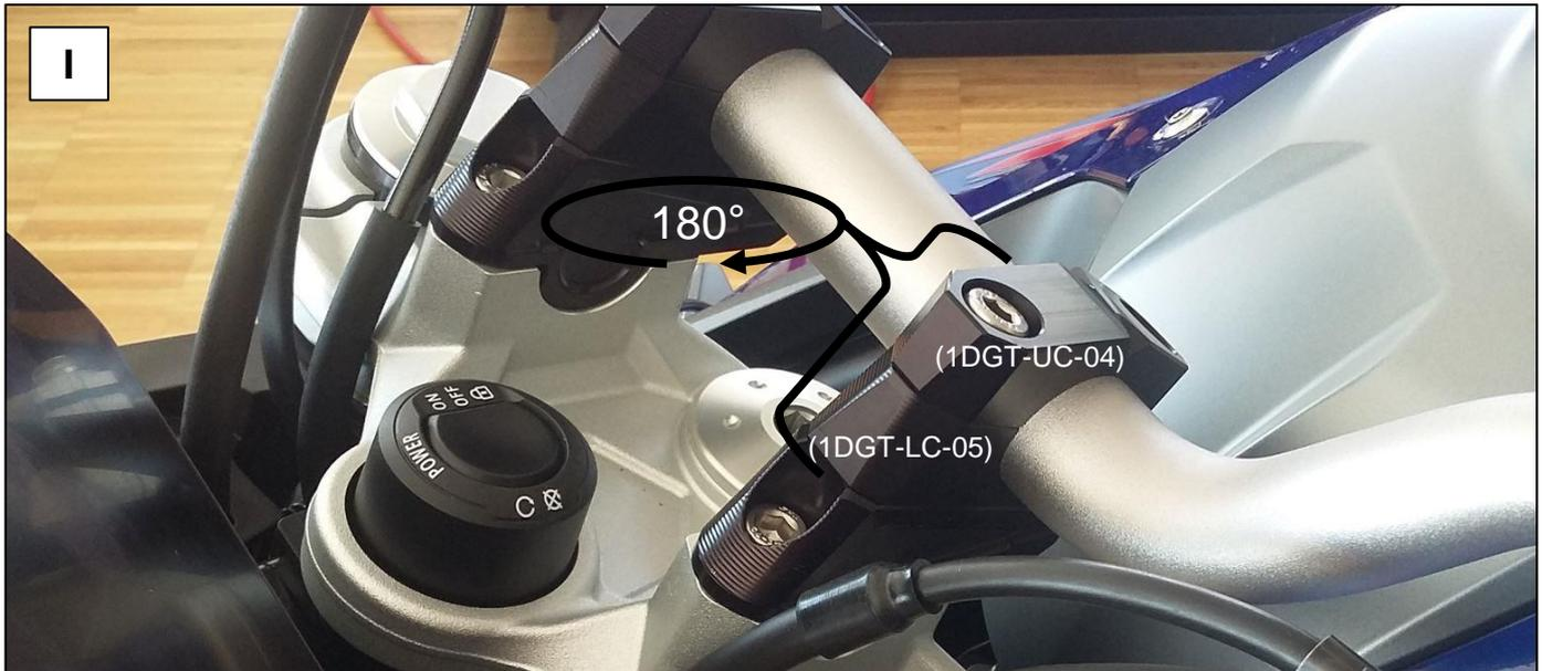
Durch verdrehen der mittleren Klemmelemente 1DGT-LC-05 und der oberen Klemmschalen 1DGT-UC-04 um 180 Grad ergibt sich eine zweite Einstellmöglichkeit (Klemmspalt ist nun gegenüberliegend). Maßunterschiede gemäß der unteren Darstellungen.
