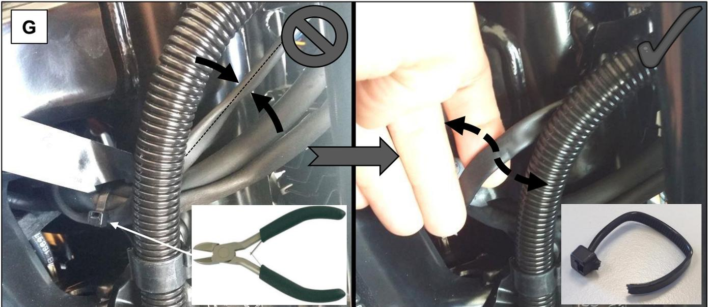
**Hinweis:** Prüfen Sie ob Kabelbäume beim Einlenken die Lenkansschläge begrenzen. Kabelbinder wie dargestellt entfernen um mehr Freigang zu erhalten (Beispielhaft an einer BMW F900R, 2020 dargestellt).
