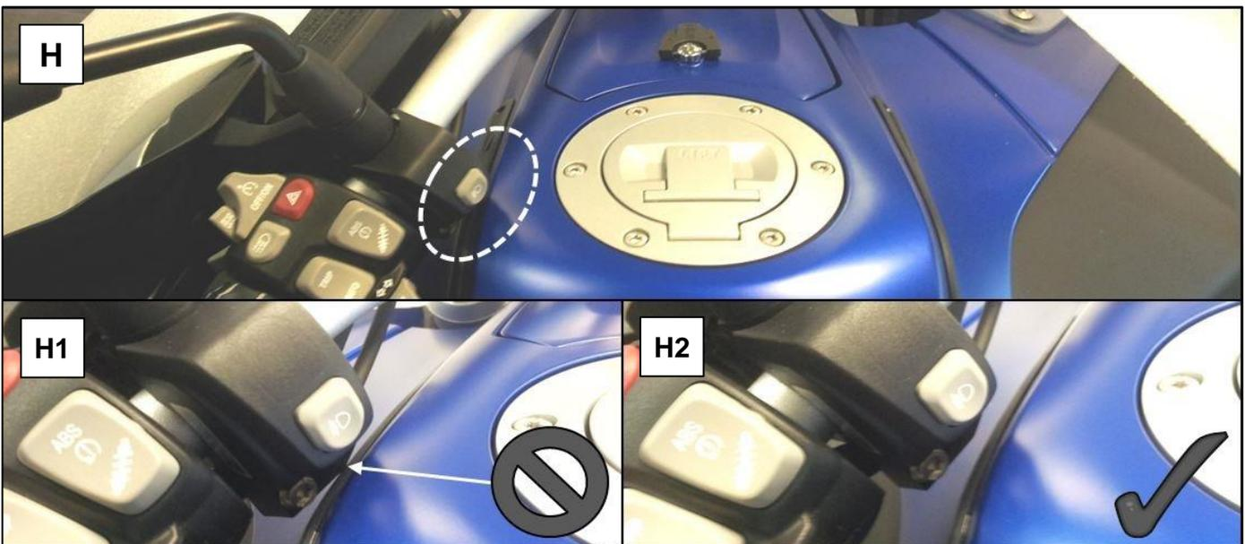
Prüfen Sie den Anbau auf Kollisionen zum Tank/ Kanzelverkleidung und die generelle Freigängigkeit durch vorsichtiges Einschlagen des Lenkers vom rechten zum linken Lenkansschlag!
