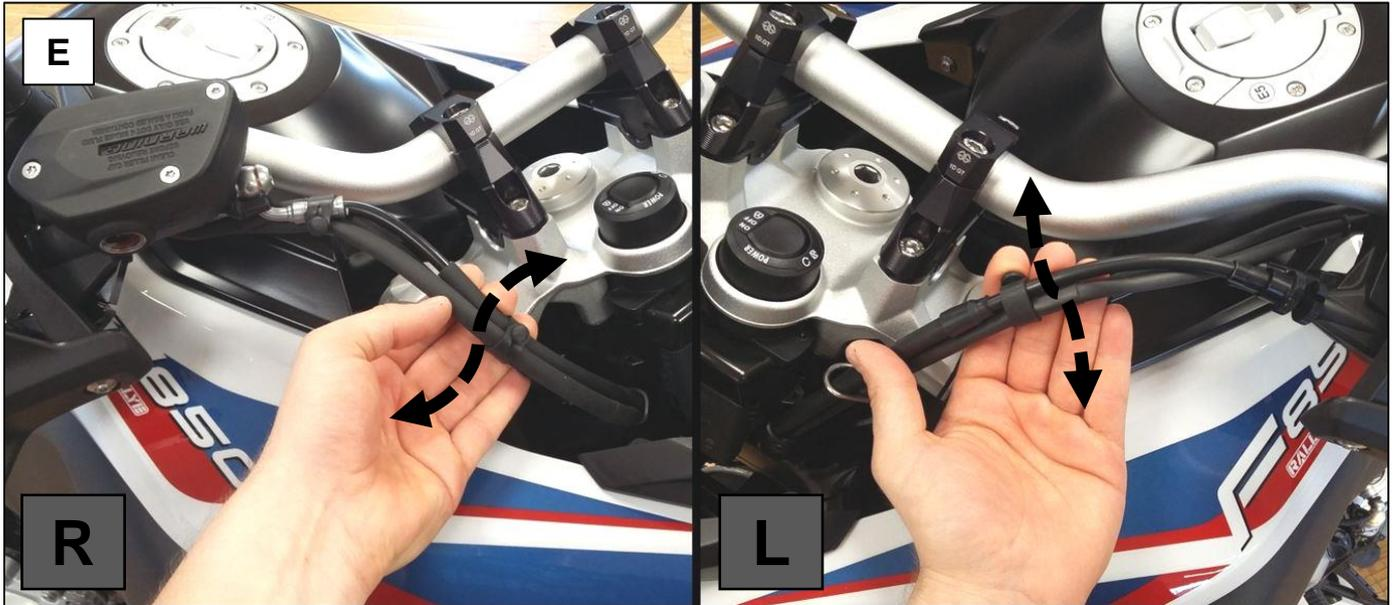
Überprüfen Sie per Hand das Spiel der Bremsleitung und des Kupplungszuges, sowie der Kabelbäume in den beiden Lenkansschlägen. Diese dürfen nicht gespannt, oder gar vor den Lenkansschlägen begrenzen werden beim Lenken!
