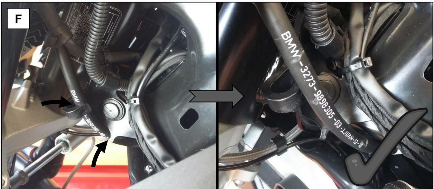
**Hinweis/ Tipp:** Falls Sie zusätzlichen Freigang beim Einlenken des Lenkers (Von Anschlag zu Anschlag) benötigen, kann optional geprüft werden ob der Kupplungszug aus seiner Halterung genommen oder anders verlegt werden kann (Beispielhaft an einer BMW F900R, 2020 dargestellt).
