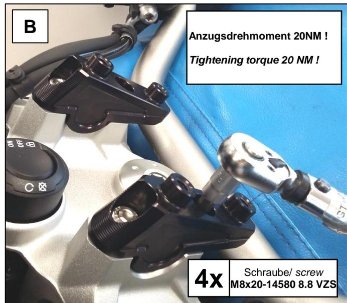
Schützen Sie Anbauteile wie beispielsweise Tank, Tachoeinheit oder Gabel! (Decken, Polyesterbeutel etc.) Entfernen Sie die originalen Oberschalen der Lenker- Klemmböcke (nicht dargestellt)!
