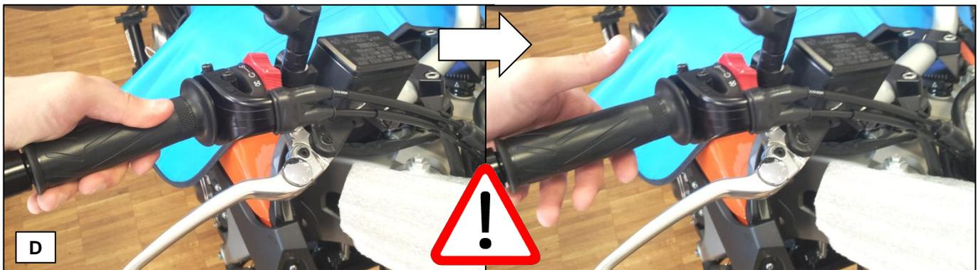
**D:** Es ist zwingend zu kontrollieren, dass der Gasgriff an beiden Lenkansschlägen nach dem Ziehen und Lösen nicht klemmt, sondern in die unbetätigte Grundstellung zurückspringt (komplett widerstandsfrei ohne leichtes Hängen)!
