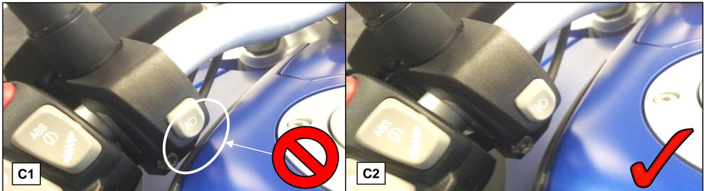
**C:** Prüfen Sie den Anbau auf Kollisionen zum Tank und Freigängigkeit durch vorsichtiges Einschlagen des Lenkers vom rechten zum linken Lenkansschlag!
