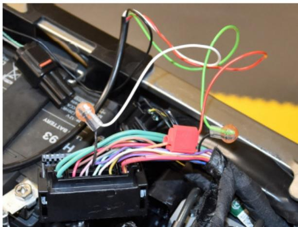
Collegare il filo ROSSO del cablaggio SpeedoHealer al filo originale di colore ARANCIONE del connettore centralina ABS utilizzando il morsetto ruba corrente fornito.
