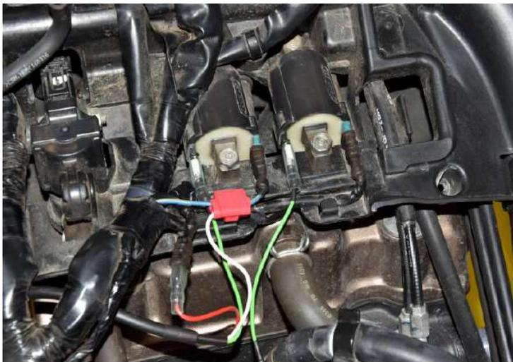
Collegare il filo Nero del cablaggio QS al terminale negativo della batteria.
