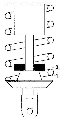
CARICARE LA RUOTA POSTERIORE PRIMA DI SERRARE LE VITI. USARE LE COPPIE DI SERRAGGIO
