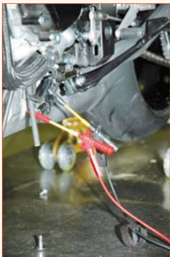
● Il Socio può funzionare come un comune multimetro digitale, usando i classici puntali universali o le pinzette rubacontatto. In questo caso, abbiamo misurato prima la tensione della sonda Lambda di una GSX-R 1000, poi quella del potenziometro farfalla.
