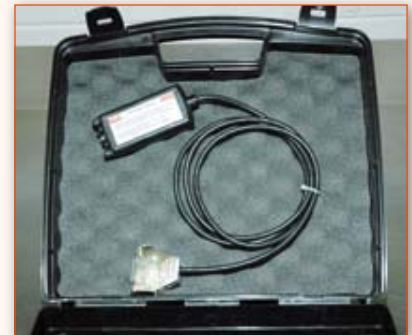
Con l'apposito strumento "Belt control sensor", è possibile eseguire il corretto tensionamento di una cinghia, semplicemente impostando i dati tecnici e geometrici di quest'ultima e ricevendo il valore corretto in Hertz a cui essa dovrà vibrare se sollecitata.
