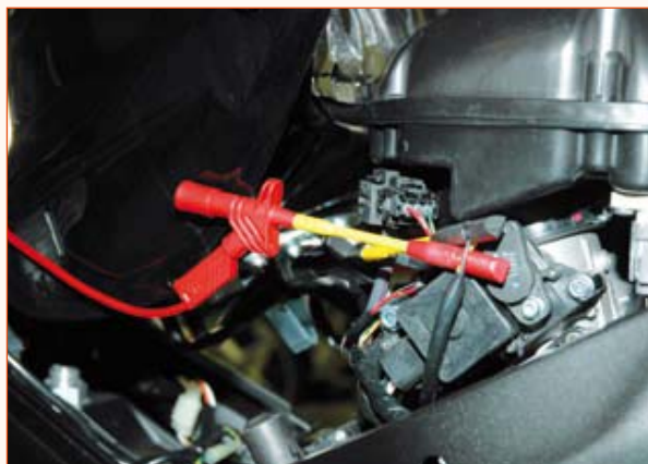
● Il Socio può funzionare come un comune multimetro digitale, usando i classici puntali universali o le pinzette rubacontatto. In questo caso, abbiamo misurato prima la tensione della sonda Lambda di una GSX-R 1000, poi quella del potenziometro farfalla.
