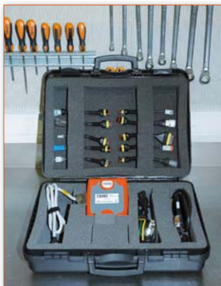
● Questa è la valigia con il modulo diagnostico e la dotazione di cavi per coprire la maggior parte dei marchi motociclistici: Aprilia, Benelli, Bimota, BMW, Cagiva, Ducati, GasGas, Gilera, Harley-Davidson, Honda, Kawasaki, Moto Guzzi, Moto Morini, MV Agusta, Peugeot, Piaggio, Sherco, Suzuki, Triumph, Yamaha.
