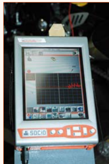
● Il Socio può funzionare come un comune multimetro digitale, usando i classici puntali universali o le pinzette rubacontatto. In questo caso, abbiamo misurato prima la tensione della sonda Lambda di una GSX-R 1000, poi quella del potenziometro farfalla.
