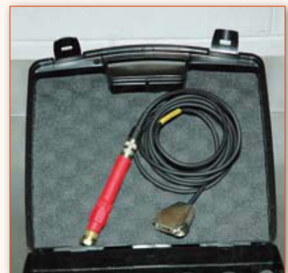
Con il Socio è possibile eseguire anche misure di compressione cilindro, con lo strumento apposito che si fissa sul sensore montato al posto della candela.
