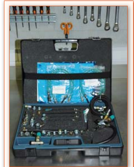
Questa è la valigetta di raccordi universali per eseguire prove di tipo pneumatico sulle tubazioni carburante.
